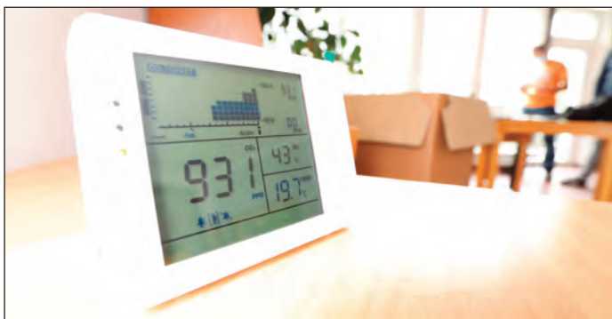
Das Kohlendioxid-Messgerät, auch CO-2-Ampel genannt, analysiert mittels Sensoren die Raumluftqualität.
