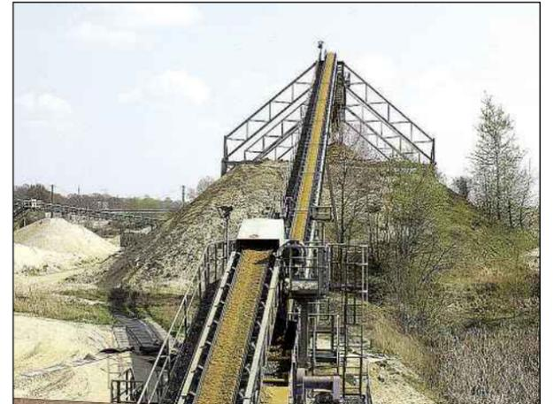
Über ein zwei Kilometer langes Band werden die wertvollen Kiessande zur Aufbereitungsanlage transportiert, wo sie gewaschen und klassiert werden.
